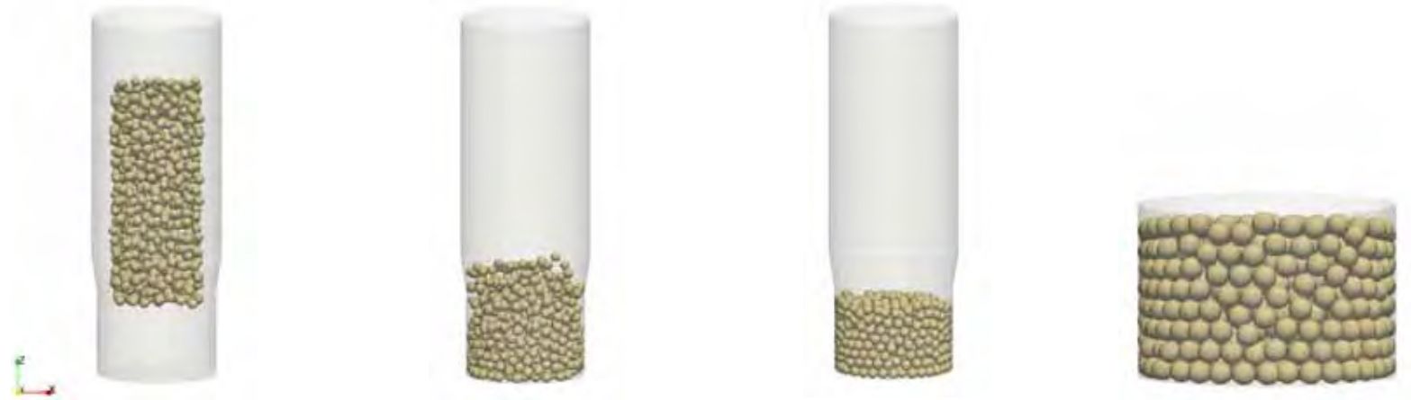
Step 1 Deposizione e stabilizzazione dell'impaccamento (DEM)
